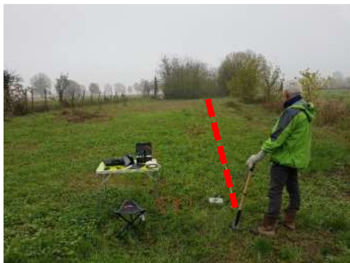
Vista stendimento MASW
